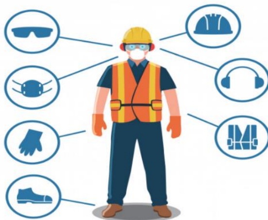
Rys. 1.4. Środki ochrony indywidualnej na stanowisku operatora maszyn CNC
