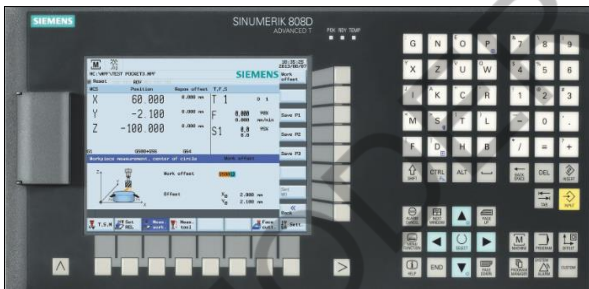
Rys. 1.60. Pulpit układu sterowania numerycznego SINUMERIK 808D – część 1
